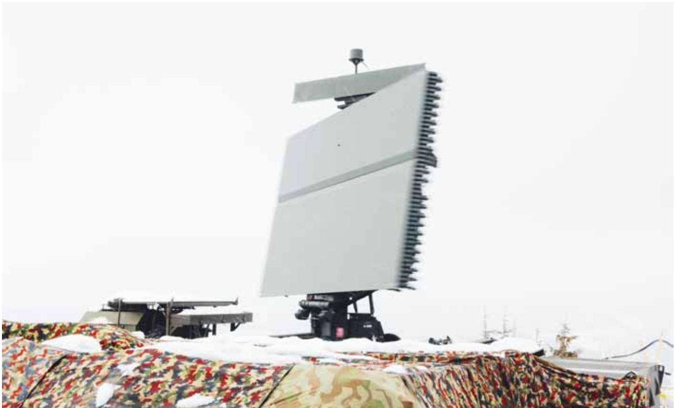
Das graugrüne Rechteck ist die Antenne des Luftwaffen-Radarsystems TAFLIR.
